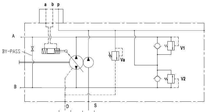
Steuerdruck: 4-16 bar [58-232 PSI] am Anschluss a + b
