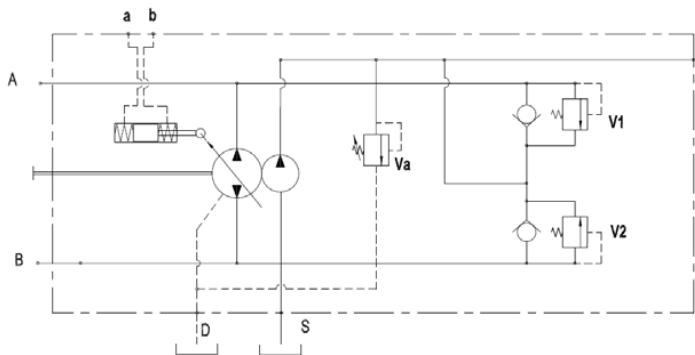
Steuerdruck: 4-16 bar [58-232 PSI] am Anschluss a + b
