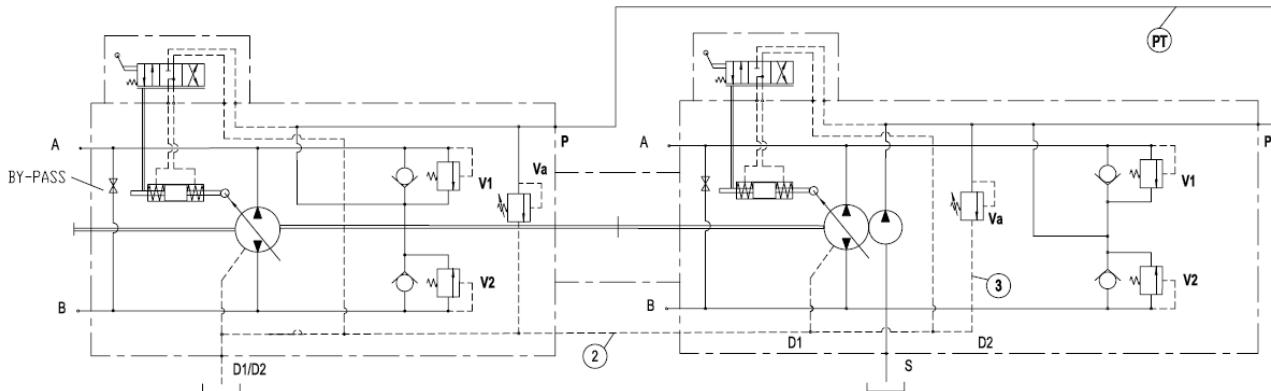
Der Schlauch (P) zur Verbindung der Druckanschlüsse (P) mit der Speisepumpe wird mit der Pumpe geliefert. Die Schläuche (2 + 3) zur Verbindung der Leckölanschlüsse gehören nicht zum Lieferumfang.
