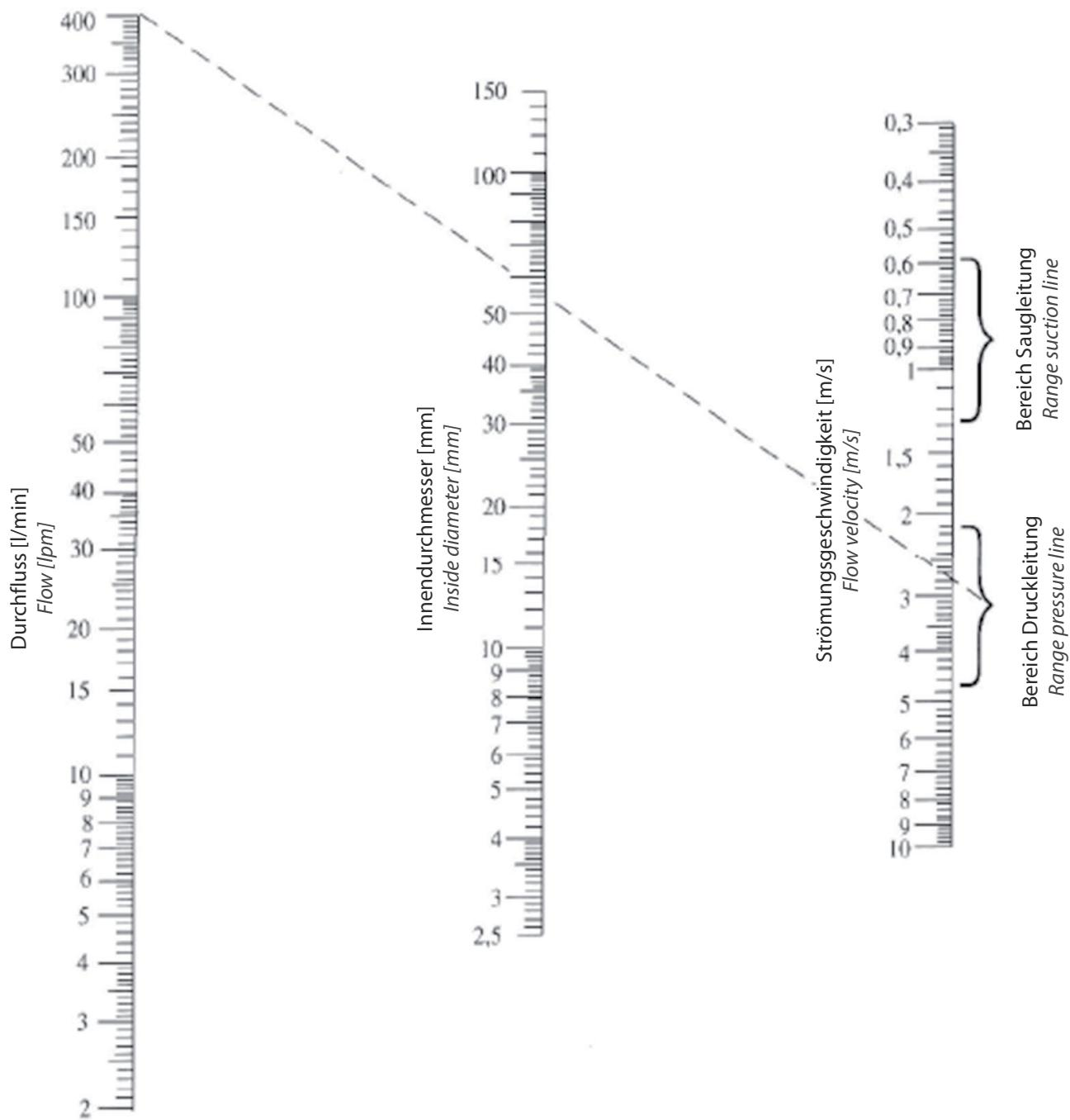
Der Innendurchmesser der zu bestimmenden Leitung wird ermittelt, indem auf den beiden äußersten Skalen eine gradlinige Verbindung zwischen Volumenstrom ( $Q$ ) und Strömungsgeschwindigkeit ( $v$ ) gezogen wird.
