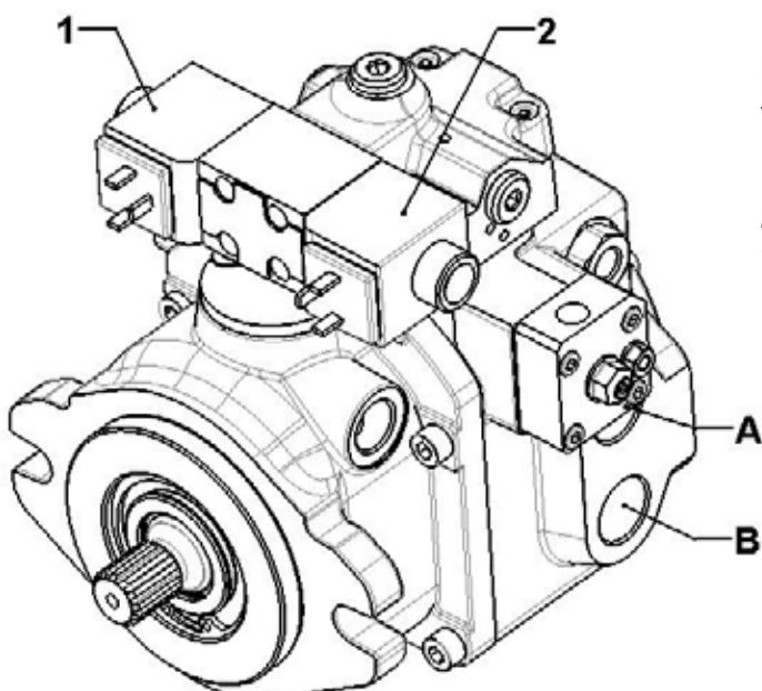
**Drehrichtung:** Zusammenhang zwischen Drehrichtung (Blick auf die Welle Richtung Gehäuse), Regler und Flussrichtung.
