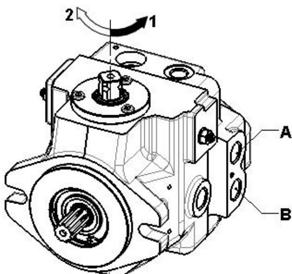
**Drehrichtung:** Zusammenhang zwischen Drehrichtung (Blick auf die Welle Richtung Gehäuse), Regler und Flussrichtung.
