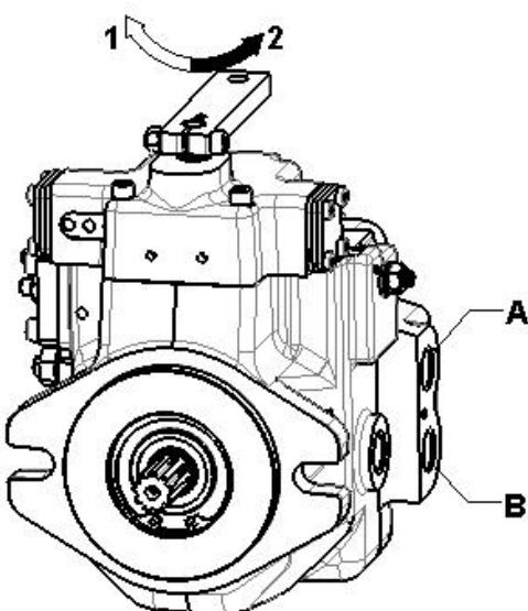
**Drehrichtung:** Zusammenhang zwischen Drehrichtung (Blick auf die Welle Richtung Gehäuse), Regler und Flussrichtung.
