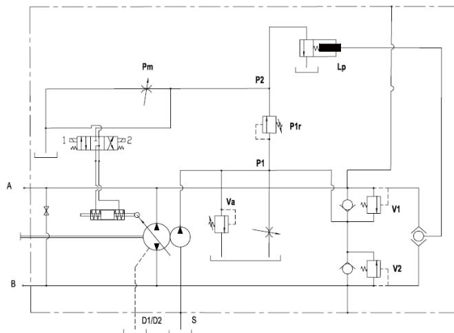
Automotiv Regler mit mechanischem Inching (Pos. 9 Option IM)
