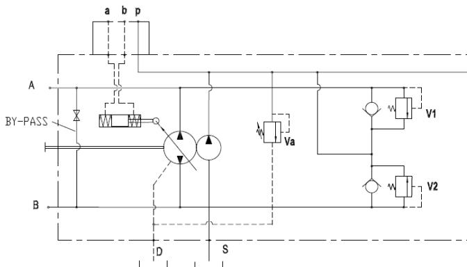
Steuerdruck: 4-16 bar [58-232 PSI] am Anschluss a + b
