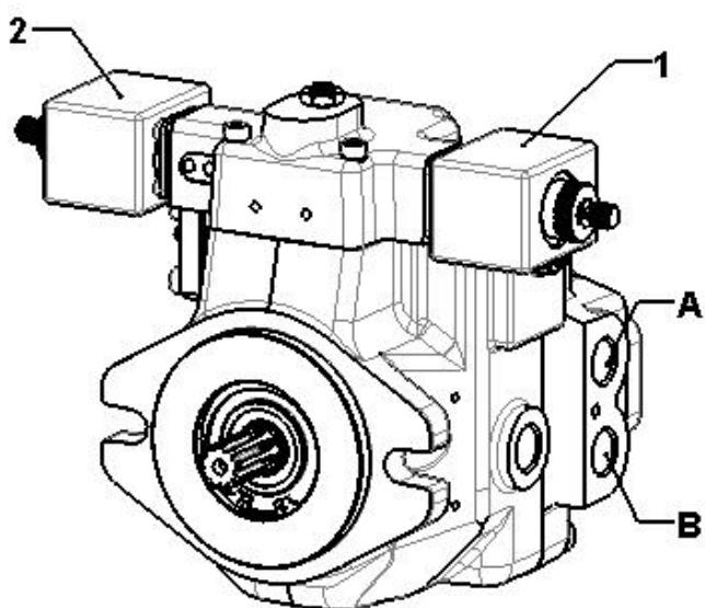
**Drehrichtung:** Zusammenhang zwischen Drehrichtung (Blick auf die Welle Richtung Gehäuse), Regler und Flussrichtung.
