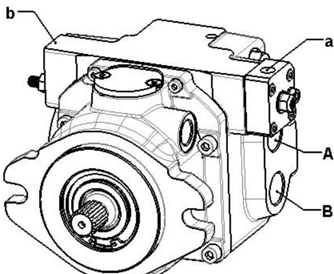
**Drehrichtung:** Zusammenhang zwischen Drehrichtung (Blick auf die Welle Richtung Gehäuse), Regler und **a** Flussrichtung.
