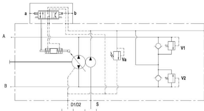
Steuerdruck: 6-16 bar [87-232 PSI] am Anschluss a + b
