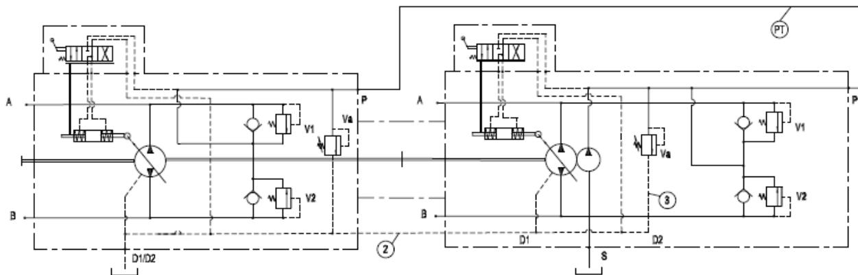
Der Schlauch (P) zur Verbindung der Druckanschlüsse (P) mit der Speisepumpe wird mit der Pumpe geliefert. Die Schläuche (2 + 3) zur Verbindung der Leckölanschlüsse gehören nicht zum Lieferumfang.
