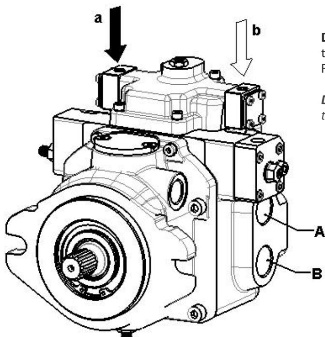
**Drehrichtung:** Zusammenhang zwischen Drehrichtung (Blick auf die Welle Richtung Gehäuse), Regler und Flussrichtung.
