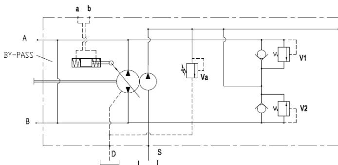
Steuerdruck: 4-16 bar [58-232 PSI] am Anschluss a + b
