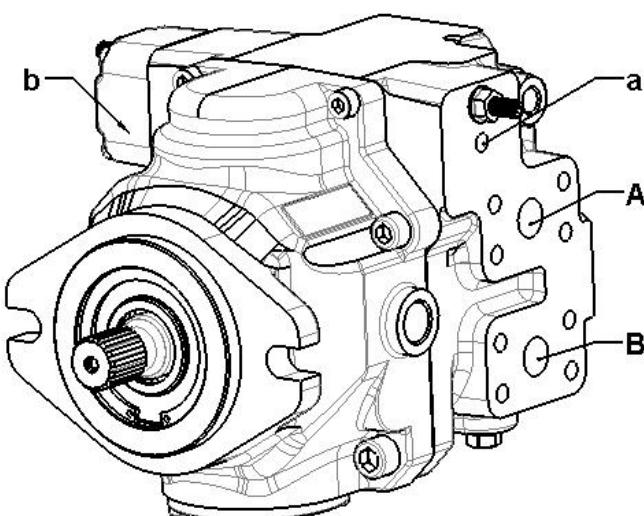
**Drehrichtung:** Zusammenhang zwischen Drehrichtung (Blick auf die Welle Richtung Gehäuse), Regler und Flussrichtung.
