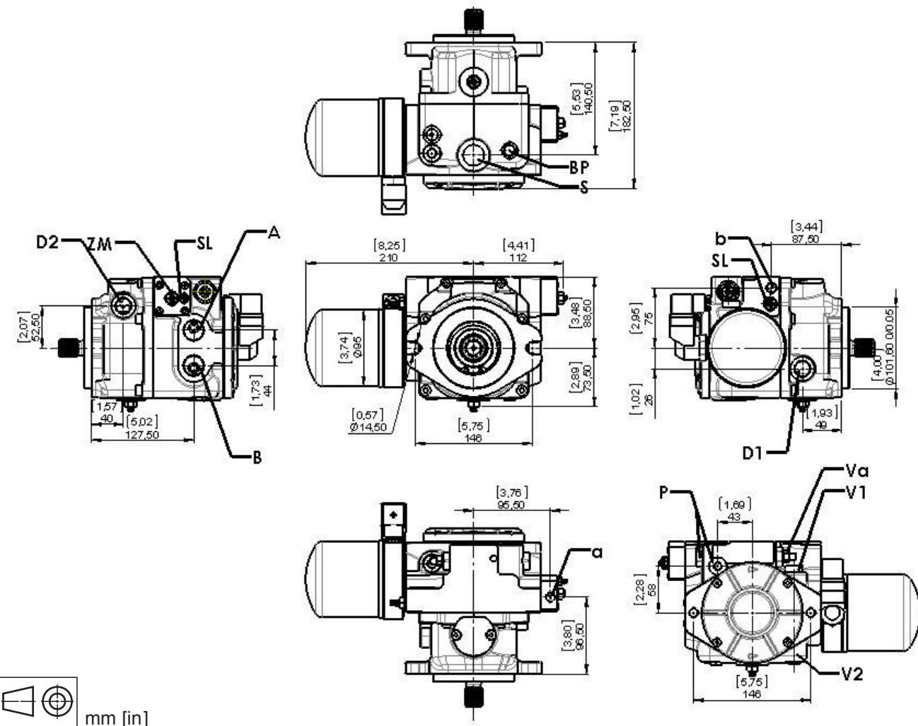
**Option P1 + P2: Absperrventil elektrisch 12V (P1) oder 24V (P2)**
