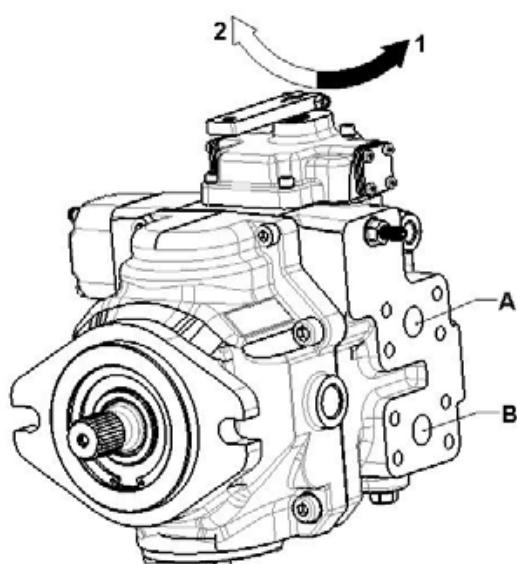
**Drehrichtung:** Zusammenhang zwischen Drehrichtung (Blick auf die Welle Richtung Gehäuse), Regler und Flussrichtung.
