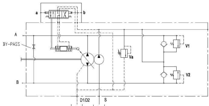
Steuerdruck: 6-16 bar [87-232 PSI] am Anschluss a + b
