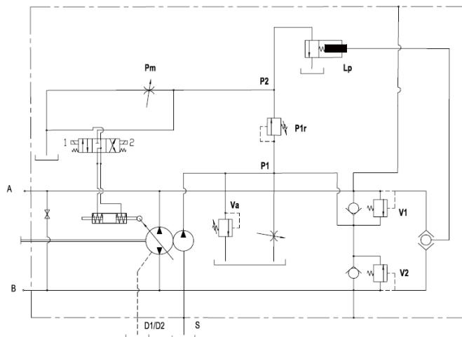
Automotiv Regler mit hydraulischem Inching (Pos. 9 Option II)
